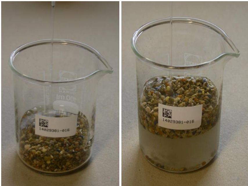
Abbildungen 5.4 und 5.5: Die Probe wird in ein Becherglas überführt und bei Bedarf wird destilliertes Wasser zugeführt.
