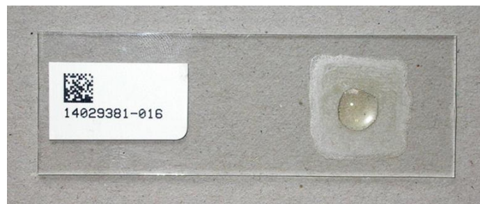
Abbildung 5.10: Das abgetrocknete Sediment wird in Glyceringelatine eingebettet.
