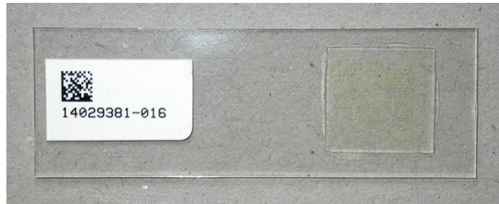
Abbildung 5.11: Abdeckung des Sediments mit einem Deckglas.
