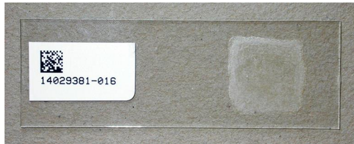
Abbildung 5.9: Aufbringen der Suspension auf Objektträger.
